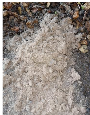
Matériaux : ZPSO-002 Prélèvement : P002 Description : Partie plane : isolant Localisation : Toiture terrasse Résultat : Absence d'amiante
