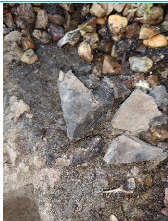
Matériaux : ZPSO-001 Prélèvement : P001 Description : Partie plane : revêtement bitumineux Localisation : Toiture terrasse Résultat : Absence d'amiante
